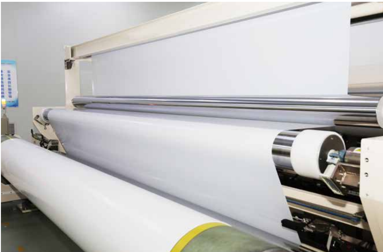
世界首条湿法双向拉伸锂电池隔膜生产线
