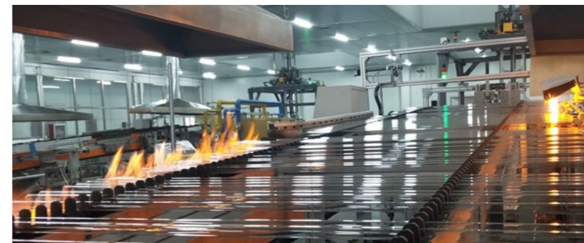
凯盛科技中性硼硅药用玻璃管生产线
